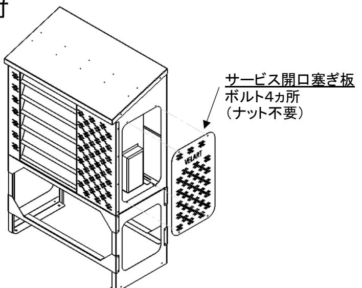
最後に全体の増し締め確認を行い、ボルトキャップを取付けてください
